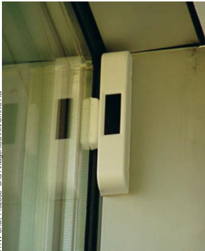
Bild 3 EnOcean-Fensterkontakt mit Solarzelle der Firma Omnio AG.
