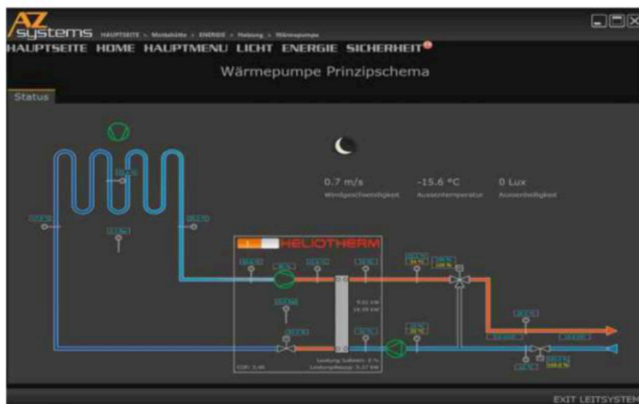
Diese Grafik zeigt das Wärmepumpen-Prinzipschema aus dem Leitsystem der AZ systems AG.
